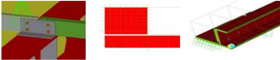
Şekil 24. Aşık-Cıvata-Korniyer Modeli, Sap2000 Korniyer Etrafı Mesnet, Profil Bitişi Kayar Mesnet
