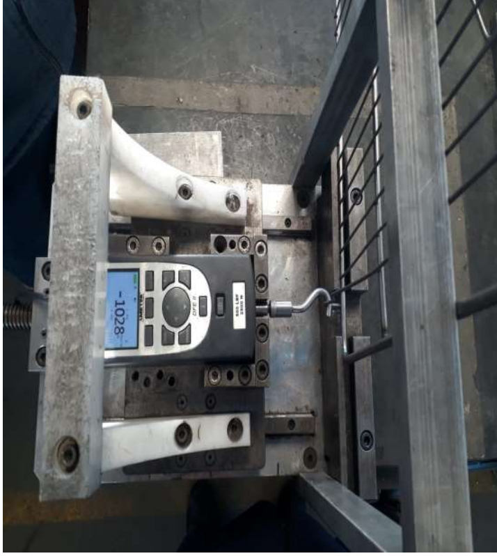
Fotoğraf 3. Çekme testlerinin yapıldığı Chatillon çekme test cihazı
